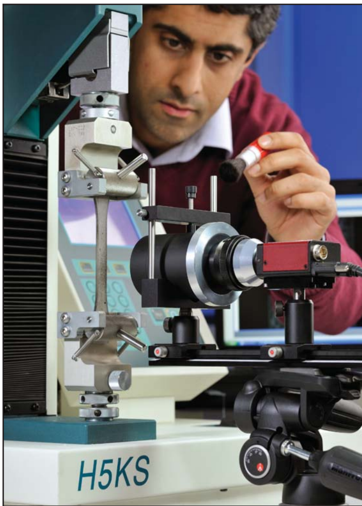
图1: HESC型视频引伸计测量塑料试样的应变能力
