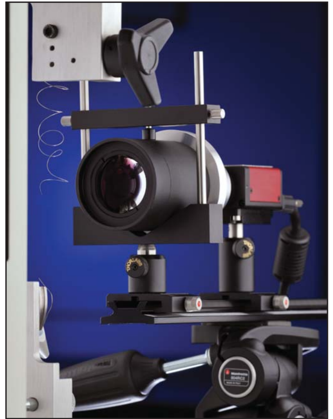
图3: LEESC型视频引伸计测量细线的应变能力
