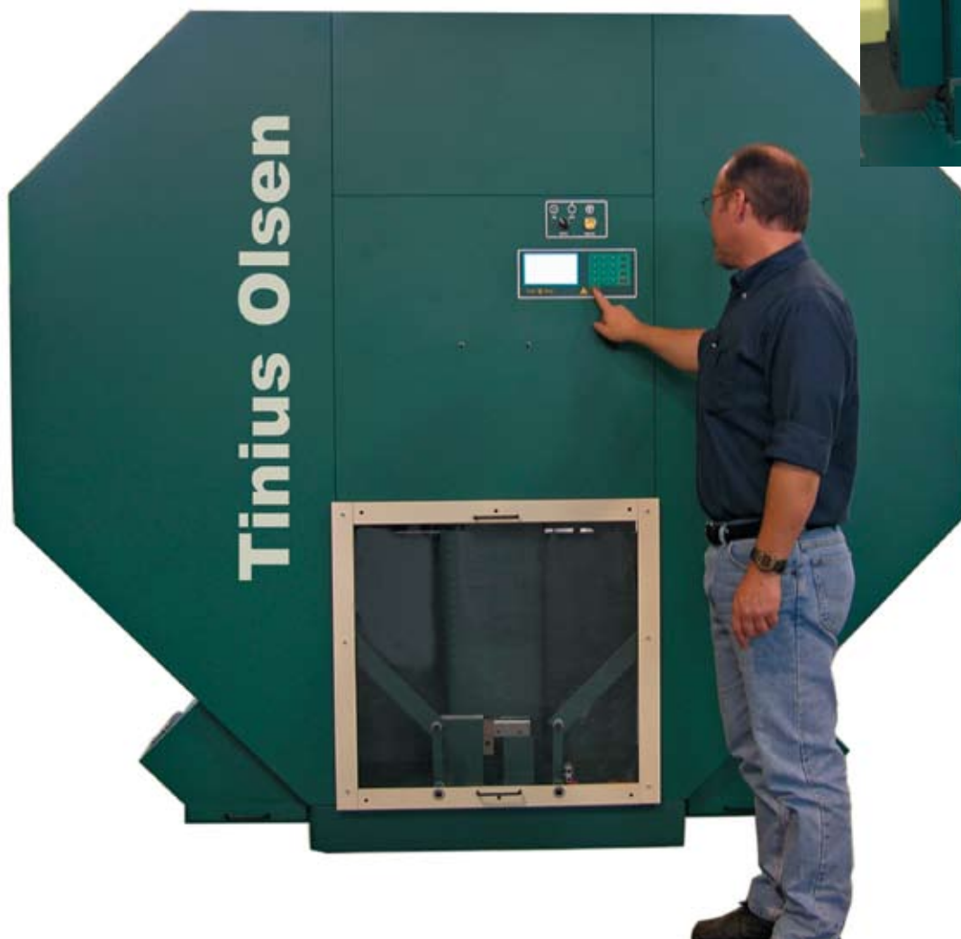
Рис.4. Маятниковый копер модели IT542 с защитным кожухом, также в комплект включены цифровой дисплей, устройство изменения “угла зарядки”, электротормоз и моторизированный подъем маятника
