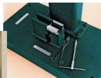
Рис.6. Наковальня Шарпи с образцом (скрыт защитными пластинами) и клещами для центровки образца
