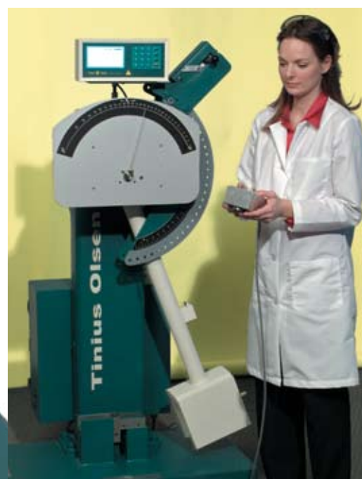
Рис.3. Маятниковый копер модели IT406M в комплекте с цифровым дисплеем, устройством для изменения “угла зарядки”, электротормозом и моторизированным подъемом маятника
