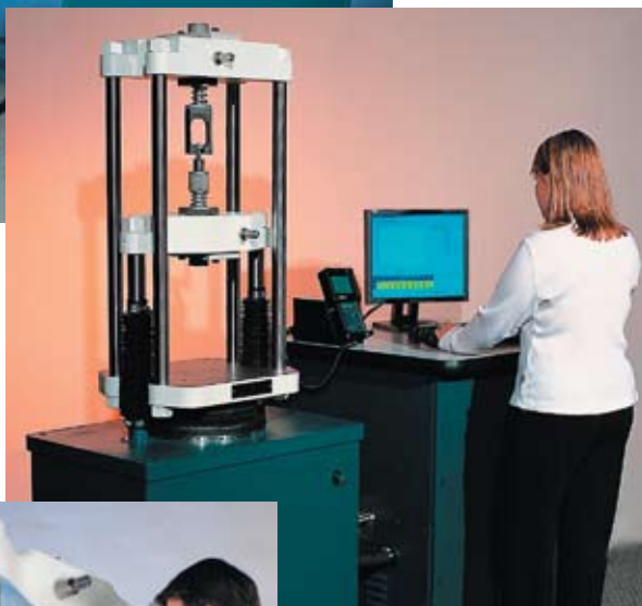
Рис. 6. Super "L 60" (300 кН) с компьютером и программным обеспечением Test Navigator
