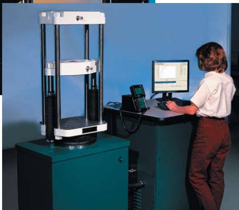
Рис. 2. Super "L60" (300 кН) с пультом управления и компьютерной системой управления
