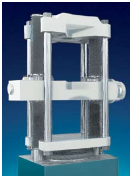
Рис. 8. Super "L 400" (2000 кН) с траверсой полуоткрытого типа
