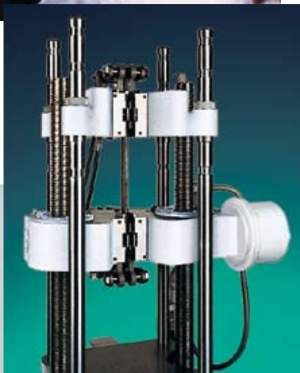
Рис. 16. Super "L120" (600 кН) с траверсой открытого типа и гидроприводом захватов; с регулировкой по высоте траверсы и колонн
