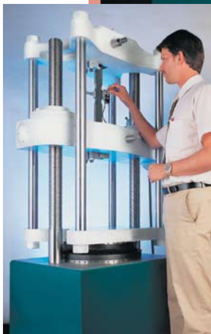
Рис. 6. Super "L 60" (300 кН) с компьютером и программным обеспечением Test Navigator
