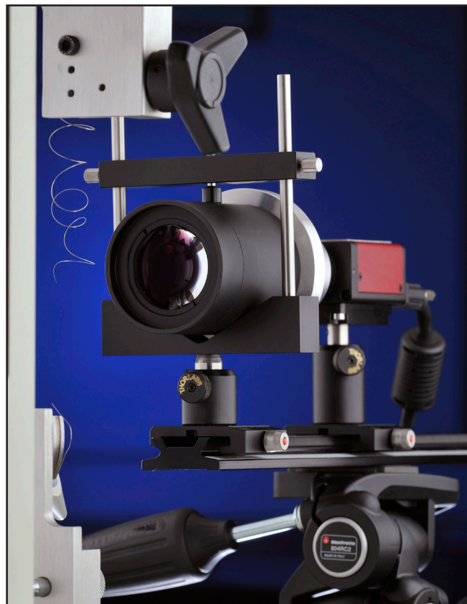
図3:LESCモデルのビデオ伸び幅計による細鋼線のひずみ測定。
