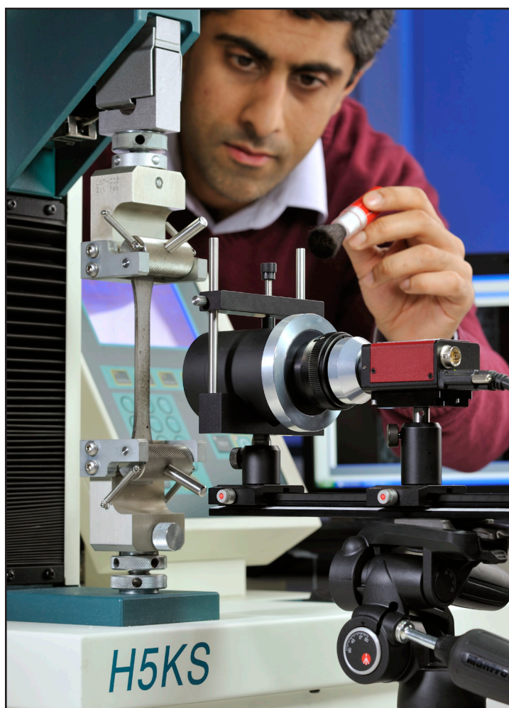
図1. プラスチック片のモデルHESCビデオ伸び測定ひずみ。
