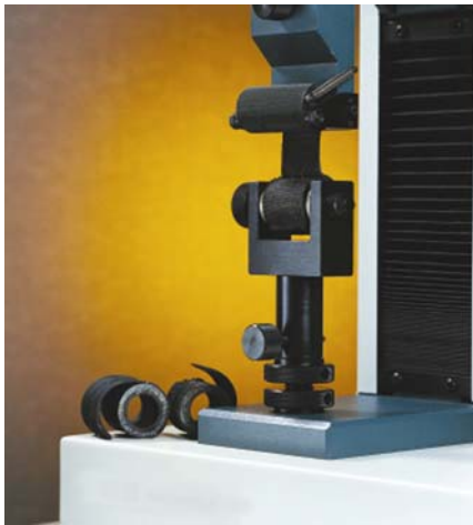
Fig 13 ゴムホースの外層の剥離強度試験 標準グリップと特注グリップの組み合わせで使用
