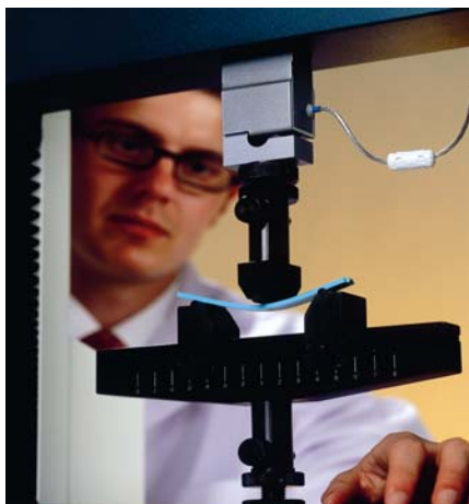
Fig 24 プラスチックの3点曲げ試験 HF72 曲げグリップ使用
