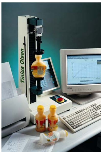
Fig3 モデル H1KS 圧縮治具付 飲料容器の圧縮試験
