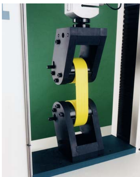
Fig 28 帯紐の引っ張り試験 HT105 グリップ使用
