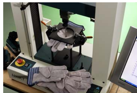
Fig 30 皮製作業用手袋の突き刺し強度試験
