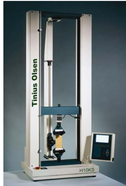
Fig 32 伸び計測計をセットした H10KS
