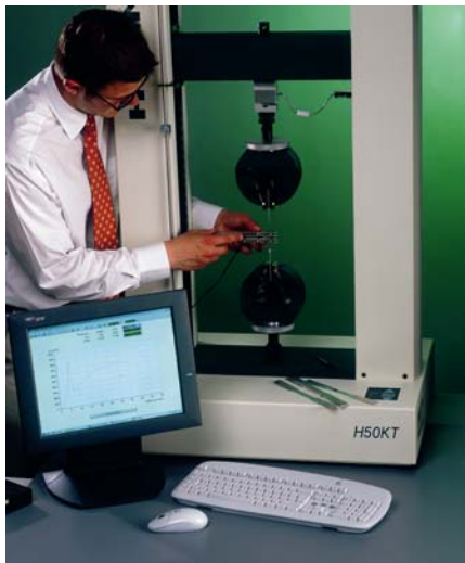
Fig 23 HT21 グリップで試験される板金のダンベル 試験サンプル
