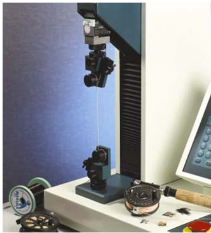
Fig 12 釣り糸の強度試験 HT33 ボーランドグリップ使用
