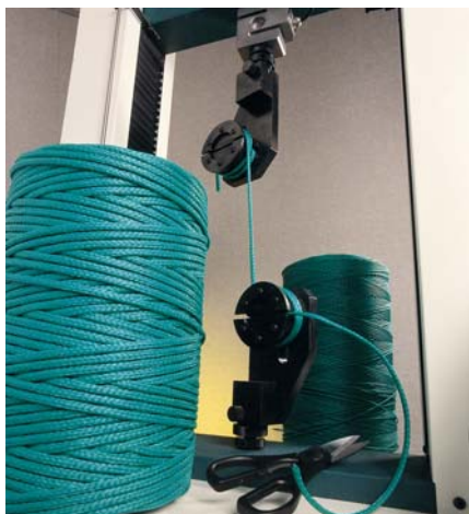
Fig 22 毛糸の引っ張り試験 分割ポーランドグリップ使用
