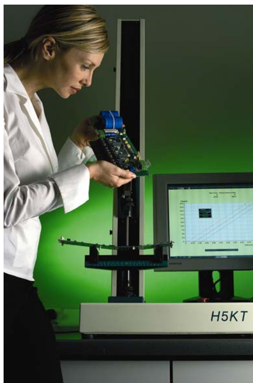
Fig4 モデル H5KT 電気配線基盤の曲げ強度試験
