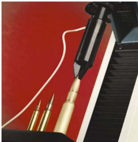
Fig 14 薬莖から弾丸の引き抜き試験 特注の空気圧式グリップ使用
