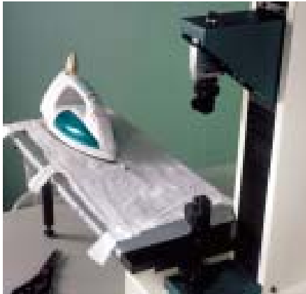
Fig 15 布の上でアイロンを動かすときの静的、動的摩擦力の点検
