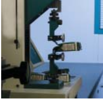
Fig 11 コーヒー容器の強度試験 HT55 クイックリリースバイスグリップ使用
