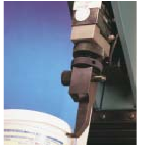
Fig 21 プラスチック容器からフタを開ける力の試験
