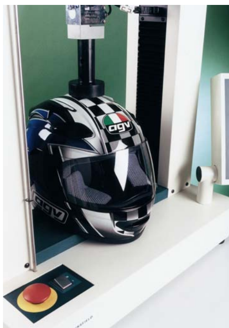
Fig 27 ヘルメットの圧縮破壊試験
