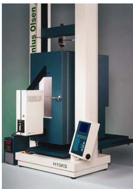
Fig 26 モデル H10KS 温度チャンバーを取り付け 温度を上下させて試験；試料の伸び率を計測 するレーザー式伸び計測計は温度チャンバー があっても使用できます
