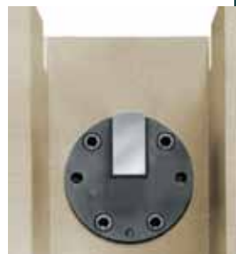
Fig. 8. Vista desde arriba de la parte baja de la cabeza del péndulo, del impactador Izod.
