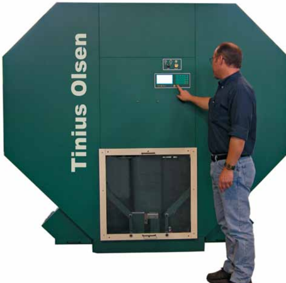
Fig. 4. Modelo IT542E completo con cubierta. La opción de la cubierta también incluye un display digital, liberación eléctrica, freno eléctrico y retorno motorizado
