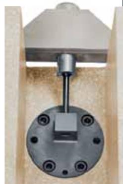
Fig. 10. Vista desde arriba de la parte inferior de la cabeza del péndulo, del impactador Impacto Tracción. Aquí podemos ver la muestra sujeta al soporte y la barra en la parte trasera del cabezal del péndulo
