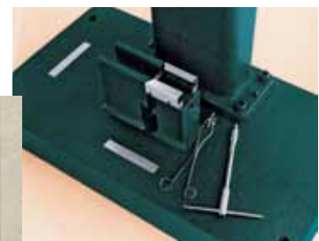
Fig. 7. Vista de la maquina base con la configuración Charpy. La muestra se coloca horizontalmente en el yunque Charpy (los cuales se ocultan con los protectores). Así mismo se pueden ver las tenazas para centrar la muestra.
