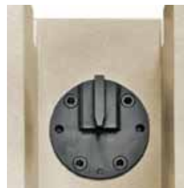
Fig. 6. Vista desde arriba de la cabeza del péndulo del impactador Charpy
